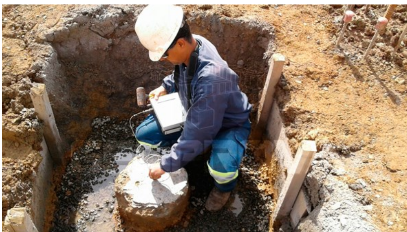
Figura 10 – Ensaio de Integridade PIT (fonte: Geoprova, 2026, disponível em: https://www.geoprova.com.br/ensaio-integridade.html , acesso em 6 mai. 2026)
